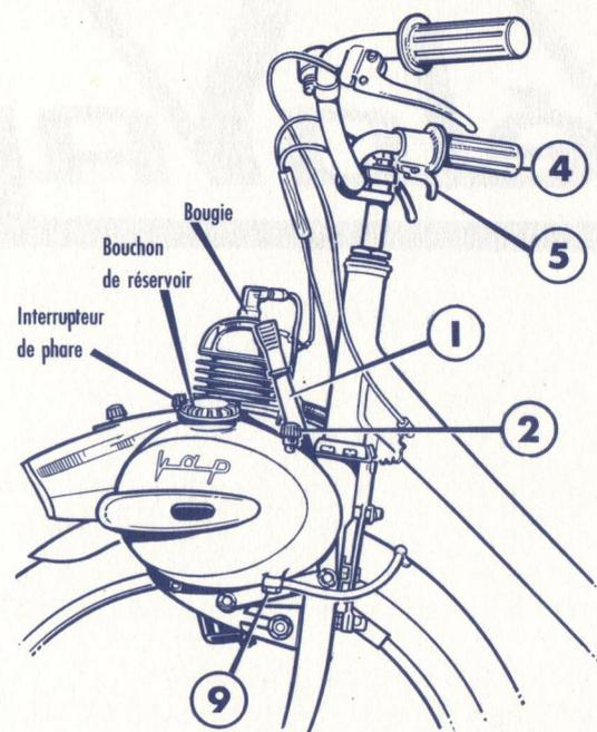
**Si le moteur est froid.** — Tirer vers le haut la commande du starter (3). Tourner à fond la poignée de commande des gaz (4). Décompresser au moyen de la gâchette (5).
